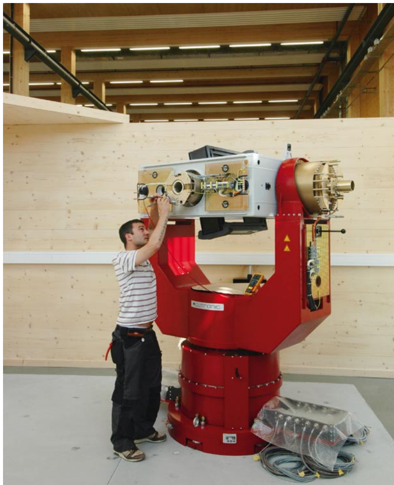
Marco Bally prüft die Verkabelung eines Bewegungssimulators (links). In den abgeschlossenen Boxen lassen sich Tests und Kalibrierungen diskret vornehmen. Um das gesamte Gebäude verlaufen mit Gitterrosten abgesetzte Aluminiumlamellen (rechts).
